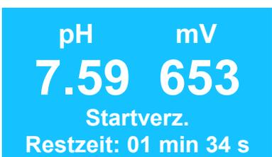
Die Dosiervverzögerung wird als Count Down auf dem Display angezeigt. Einstellbereich: 00 ... 60 Minuten.
