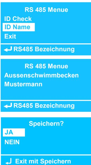
Drücken Sie im Hauptmenü den Encoder auf der Position „Kommunikation“ und dort auf „RS485 Schnittstelle“, um das Untermenü zu öffnen.
