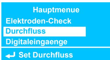
Drücken Sie im Hauptmenü den Encoder auf der Position „Durchfluss“, um das Untermenü zu öffnen.
