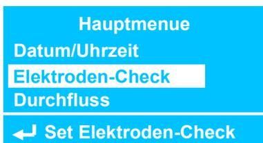
Drücken Sie im Hauptmenü den Encoder auf der Position „Elektroden-Check“, um das Untermenü zu öffnen.
