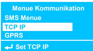
Drücken Sie im Hauptmenü den Encoder auf der Position „Kommunikation“ und dort auf „TCP IP“, um das Untermenü zu öffnen.
